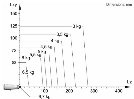
Der KR 6 R900-2 ist ausgelegt für eine Nenn-Traglast von 3 kg, um die Performance und Dynamik des Roboters optimal zu nutzen. Mit reduziertem Lastabstand und günstigen Zusatzlasten, kann eine maximale Traglast bis zu 6,7 kg angebracht werden. Der spezifische Lastfall muss mit KUKA Load überprüft werden. Für weitere Beratung steht der KUKA Service zur Verfügung.
