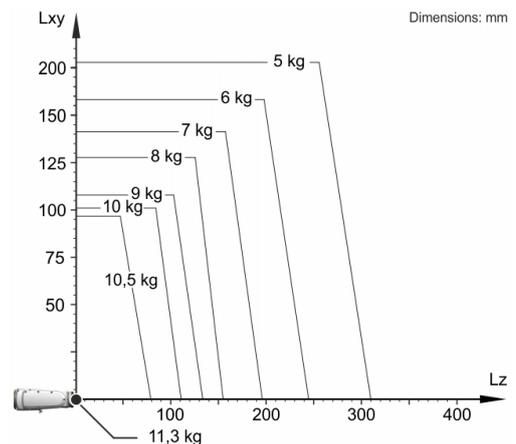
Der KR 10 R900-2 ist ausgelegt für eine Nenn-Traglast von 5 kg, um die Performance und Dynamik des Roboters optimal zu nutzen. Mit reduziertem Lastabstand und günstigen Zusatzlasten, kann eine maximale Traglast bis zu 11,3 kg angebracht werden. Der spezifische Lastfall muss mit KUKA Load überprüft werden. Für weitere Beratung steht der KUKA Service zur Verfügung.
