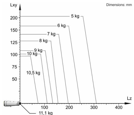
Der KR 10 R1100-2 ist ausgelegt für eine Nenn-Traglast von 5 kg, um die Performance und Dynamik des Roboters optimal zu nutzen. Mit reduzierten Lastabständen und günstigen Zusatzlasten, kann eine maximale Traglast bis zu 11,1 kg angebracht werden. Der spezifische Lastfall muss mit KUKA Load überprüft werden. Für weitere Beratung steht der KUKA Service zur Verfügung.
